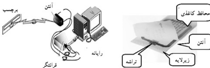
شکل ۳: اجزای سامانه RFID و ساختار یک نمونه از برچسب‌های RFID نوع غیر فعال (۲۲)
