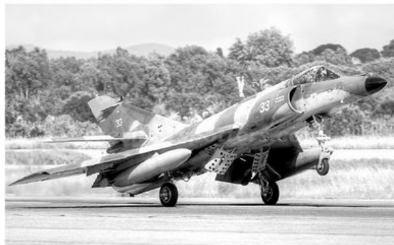
هوایمای جنگنده سوپراتاندارد، ساخت فرانسه شعاع عمل (رفت و برگشت) ۲۰۰۰ کیلومتر، مجهز به موشک اگزوسه برای زدن کشتی، توانایی حمل ۲ بمب ۲۵۰ و ۴ بمب ۴۰۰ کیلوگرمی
